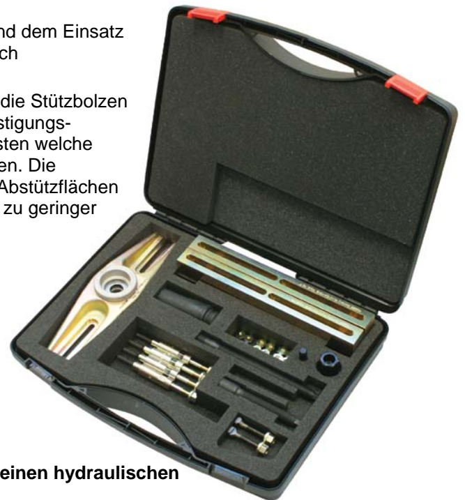
Einspritzdüse hydraulisch herausziehen
